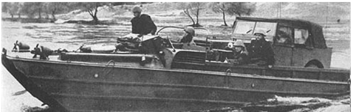
BAV setzt einen Gelände-PKW P-3 über
