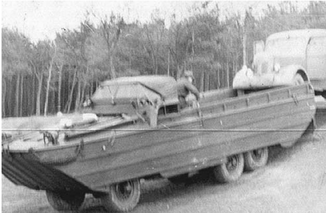
Beladen des BAV mit einem Klein-LKW Garant
