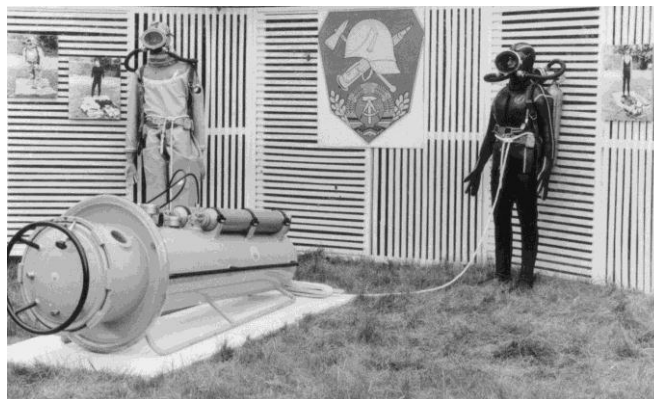
Tauchanzüge, im Vordergrund die Druckkammer
